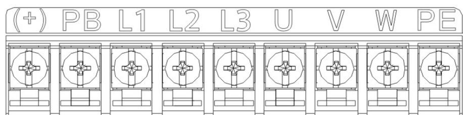
Рис. 5-5 Клеммы силовых цепей 3 фазы 380В до 2,2 кВт.
