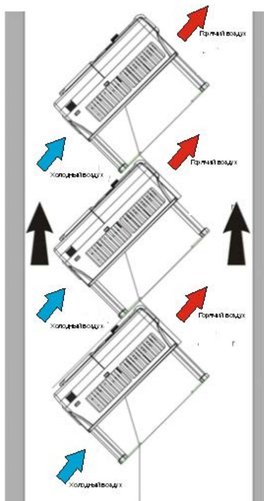
Рис. 4-5 Наклонная установка
