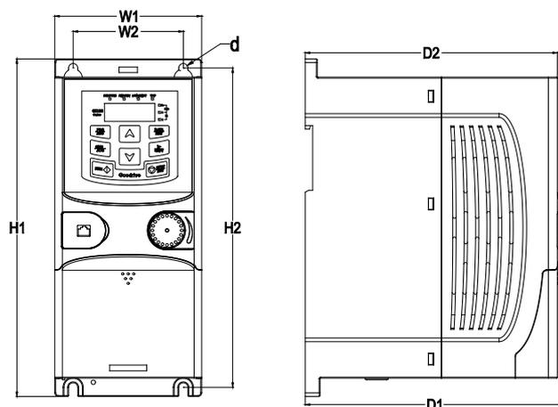
Рис. 4.6 Настенный монтаж 0,4 – 2,2 кВт
