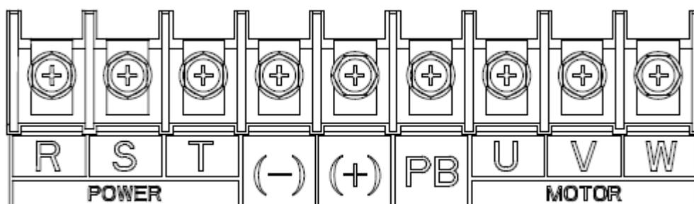
Рис. 5-8 Клеммы силовых цепей 3 фазы 380В от 45 до 55 кВт.
