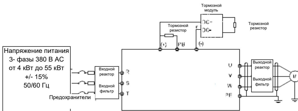
Рис. 5-3.2. Подключение силовых цепей
