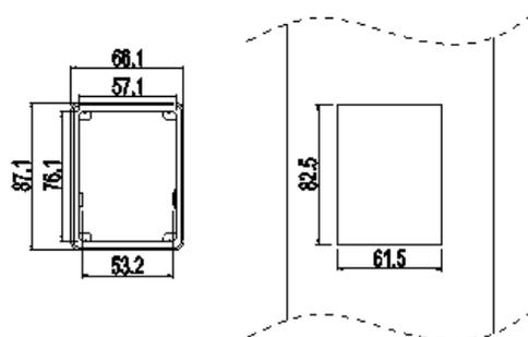
Рисунок 4-12. Настенное крепление      Установочное отверстие
