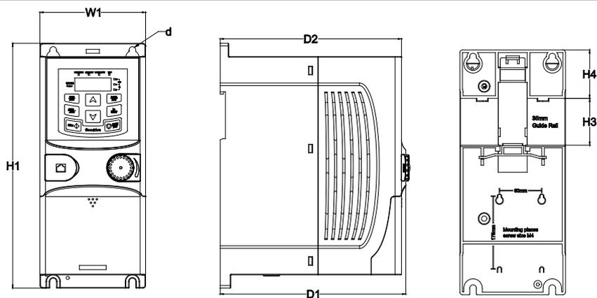
Рис. 4.7 Монтаж на DIN-рейку 0,4 – 2,2 кВт
