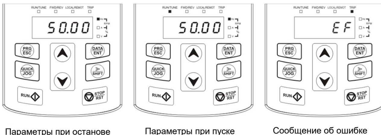
Рис. 6-3 Отображение состояния на дисплее
