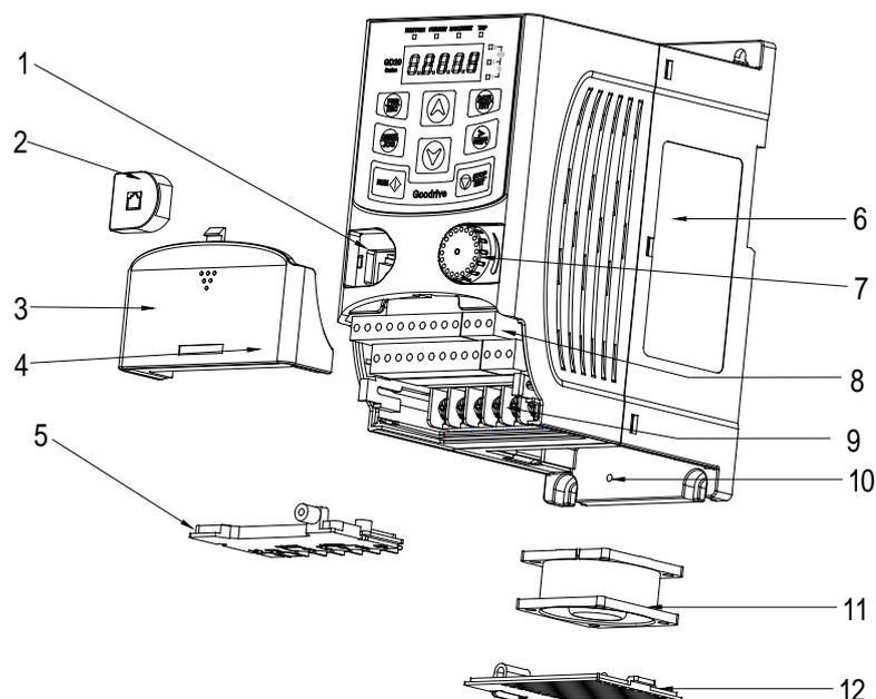
Рисунок 3-1. Структурная схема преобразователя частоты GD20.
