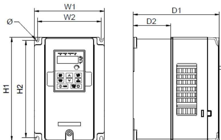
Рис. 4.8 Настенный монтаж 4 – 37 кВм
