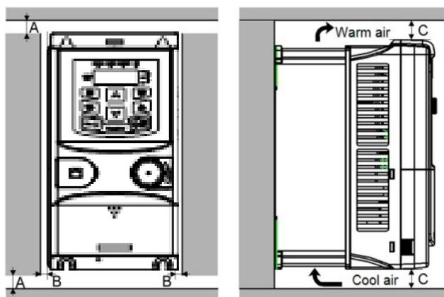
Рисунок 4-13. Вентиляционные промежутки
