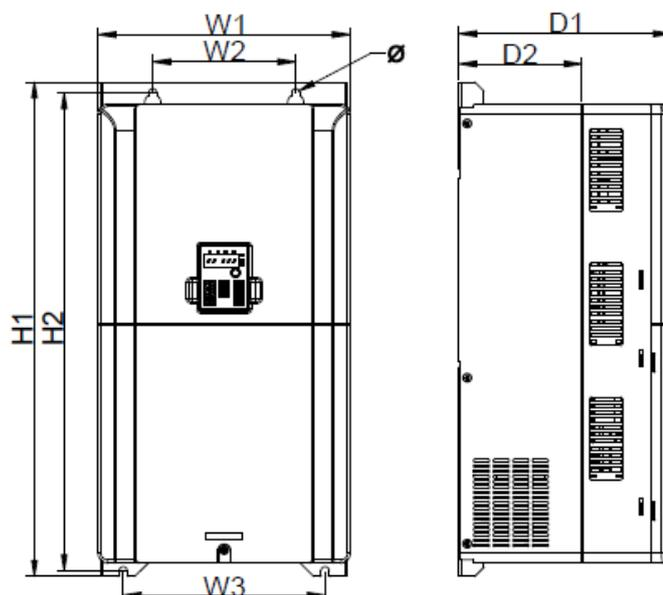
Рис. 4.9 Настенный монтаж 45 – 55 кВм
