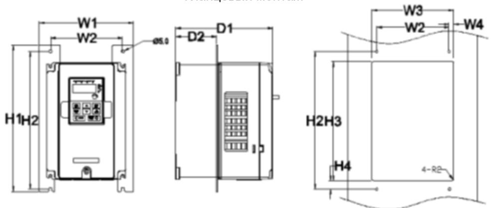
Рис. 4.10 Фланцевый монтаж 4 – 55 кВт
